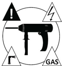
DE Bevor Sie zur Bohrmaschine greifen, sollten Sie in jedem Fall in der Wand nach Strom-, Wasser- und Gasleitungen suchen. Nur wenn Sie genau wissen, wo die Leitungen verlaufen, können Sie Beschädigungen mit hohen Folgekosten oder gar lebensgefährliche Unfälle vermeiden.
